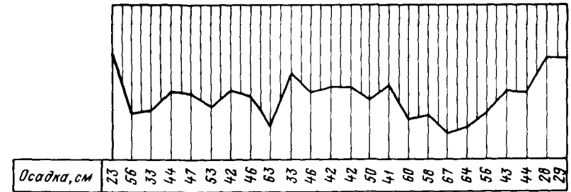
Рис. 4.18. График осадки поверхности по створу А-А на рис. 4.17
