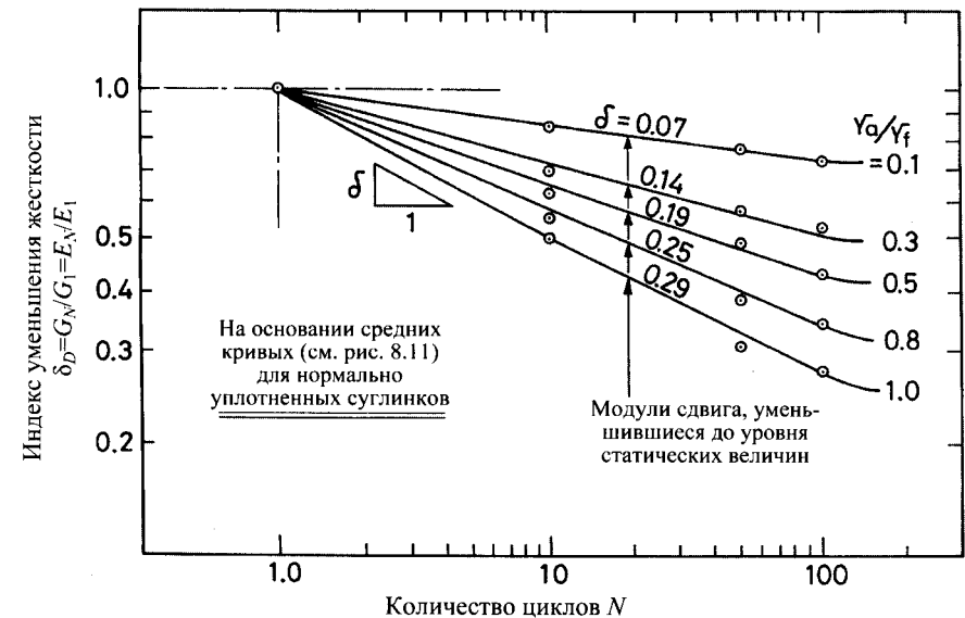
Рис. 8.12. Уменьшение модуля с ростом циклов нагружения
