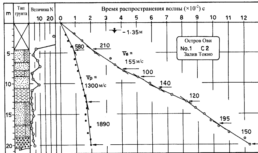
Рис. 5.7. Пример измерения скорости волн с помощью метода прямого сейсмического каротажа (downhole method)
