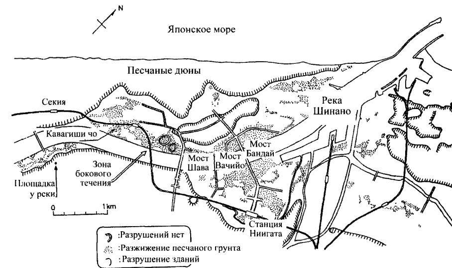
Рис. 13.1. Схема расположения мостов в городе Ниигата
