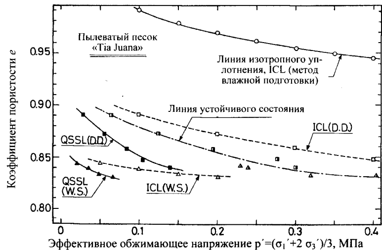
Рис. 11.15. Линии устойчивого (SSL) и квазиустойчивого (QSSL) состояний образцов пылеватого песка «Tia Juana»
