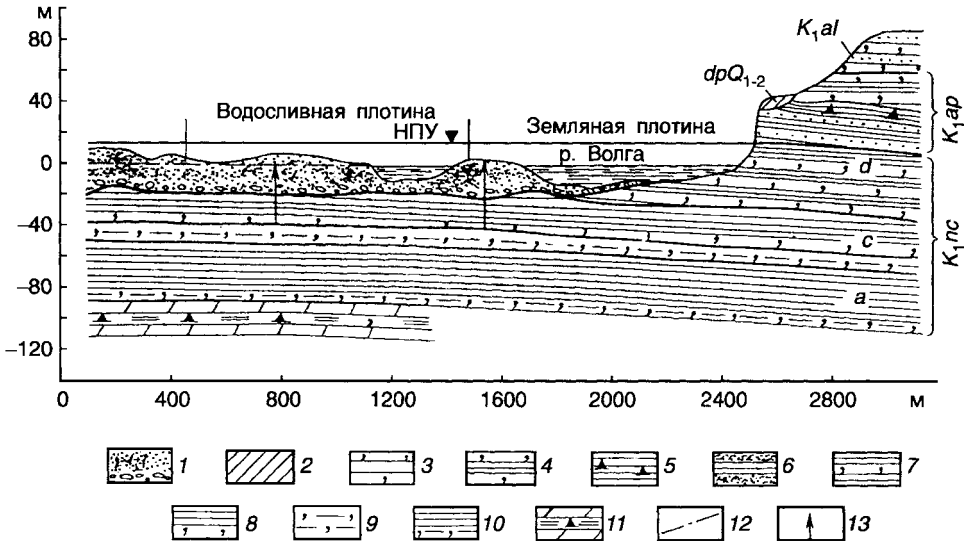
Рис. 31.15. Строение массива дисперсных грунтов по оси Саратовской ГЭС на Волге (по Н.И.Калмыковой, 1972):
