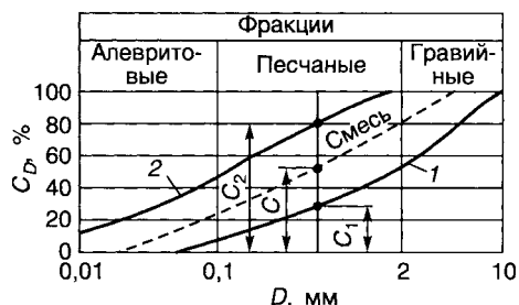
Рис. 7.4. График гранулометрического состава для подбора смеси из двух грунтов (по М.Н.Гольдштейну, 1973)
