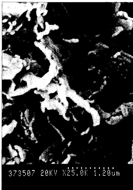
Рис. 3.37. Техногенное органическое загрязнение в юрских глинах, сформировавшееся за счет миграции осадка сточных вод (ОСВ)
