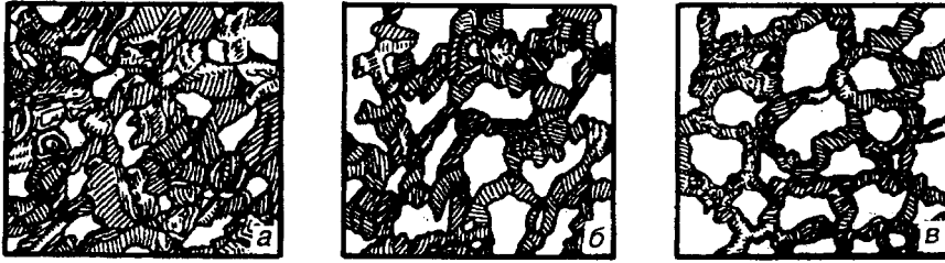
Рис. 9.19. Структуры пылевато-песчаных грунтов (по К.Терцаги):
