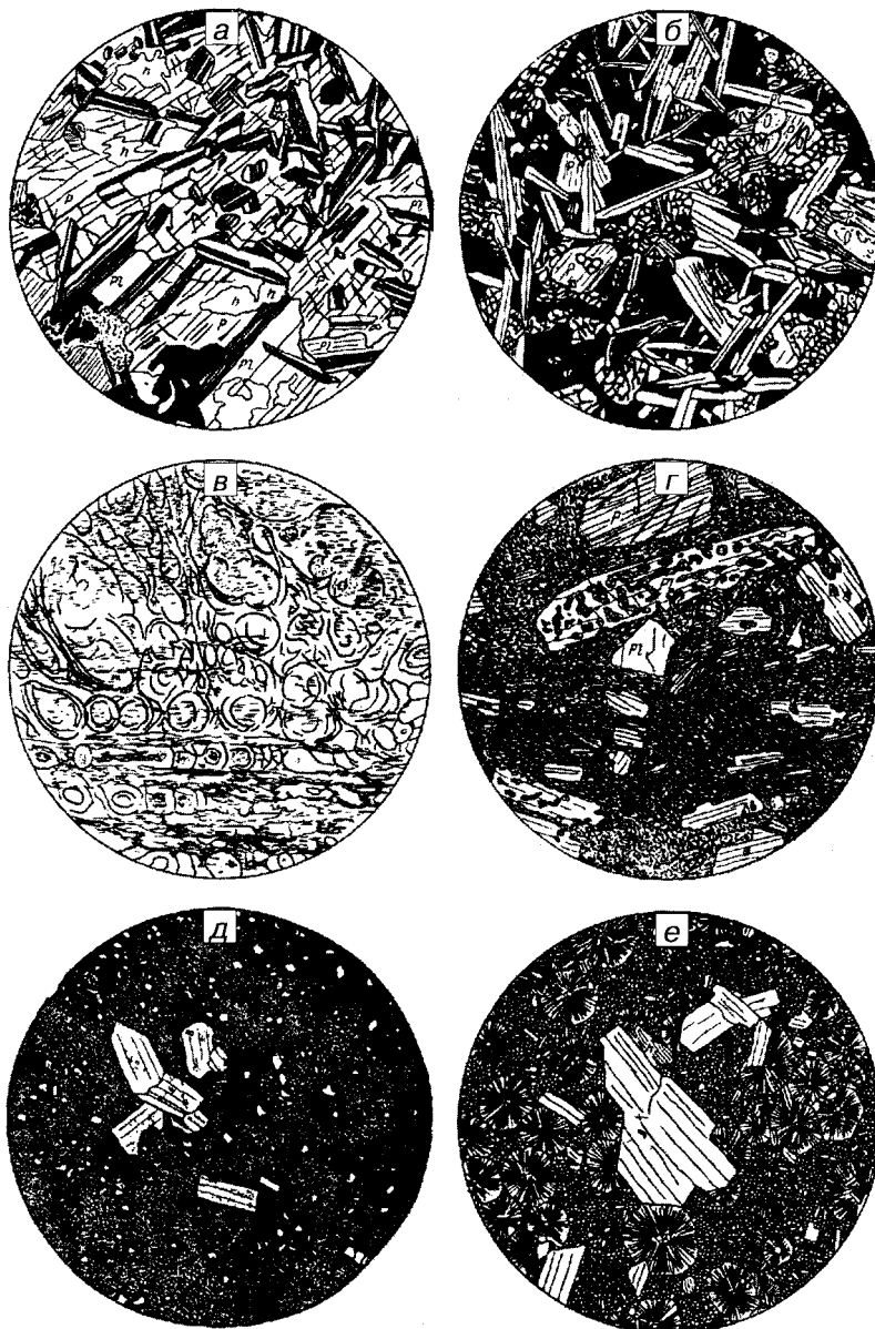
Рис. 9.12. Структуры магматических грунтов (по Е.А.Кузнецову, 1970):
