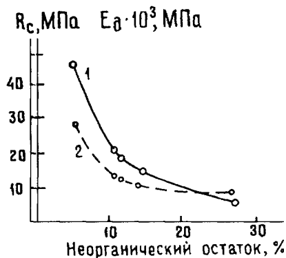
Рис. 17.12. Влияние содержания глинистого вещества на физико-механические свойства карбонатных пород (по А.Махфузу):
