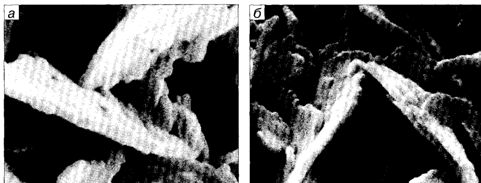
Рис 8.10. Коагуляционные контакты типа «базис—скол» (а) и «скол—скол» (б) в глине (по В.Н.Соколову, 1984)
