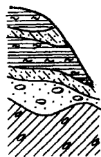
Рис. 31.11. Строение массива дисперсных грунтов в основании плотины Каунасской ГЭС на р. Неман (по данным Гидропроекта):
