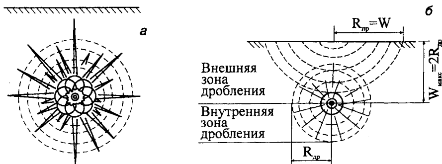
Рис. 14.112. Формирование зон трещиноватости в грунтах при камуфлетном (а) и приповерхностном (б) подземном взрыве
