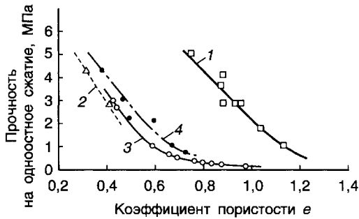
Рис. 14.49. Зависимость прочности на одноосное сжатие глин от коэффициента пористости:
