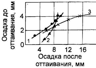
Рис. 19.6. Взаимосвязь осадки штампом до и после оттаивания андезитов (по А.А.Кагану, Н.Ф.Кривоноговой, 1978):
